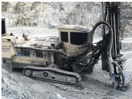
รูปที่ 2-26: รถเจาะระเบิดแบบตีนตะขาบ
